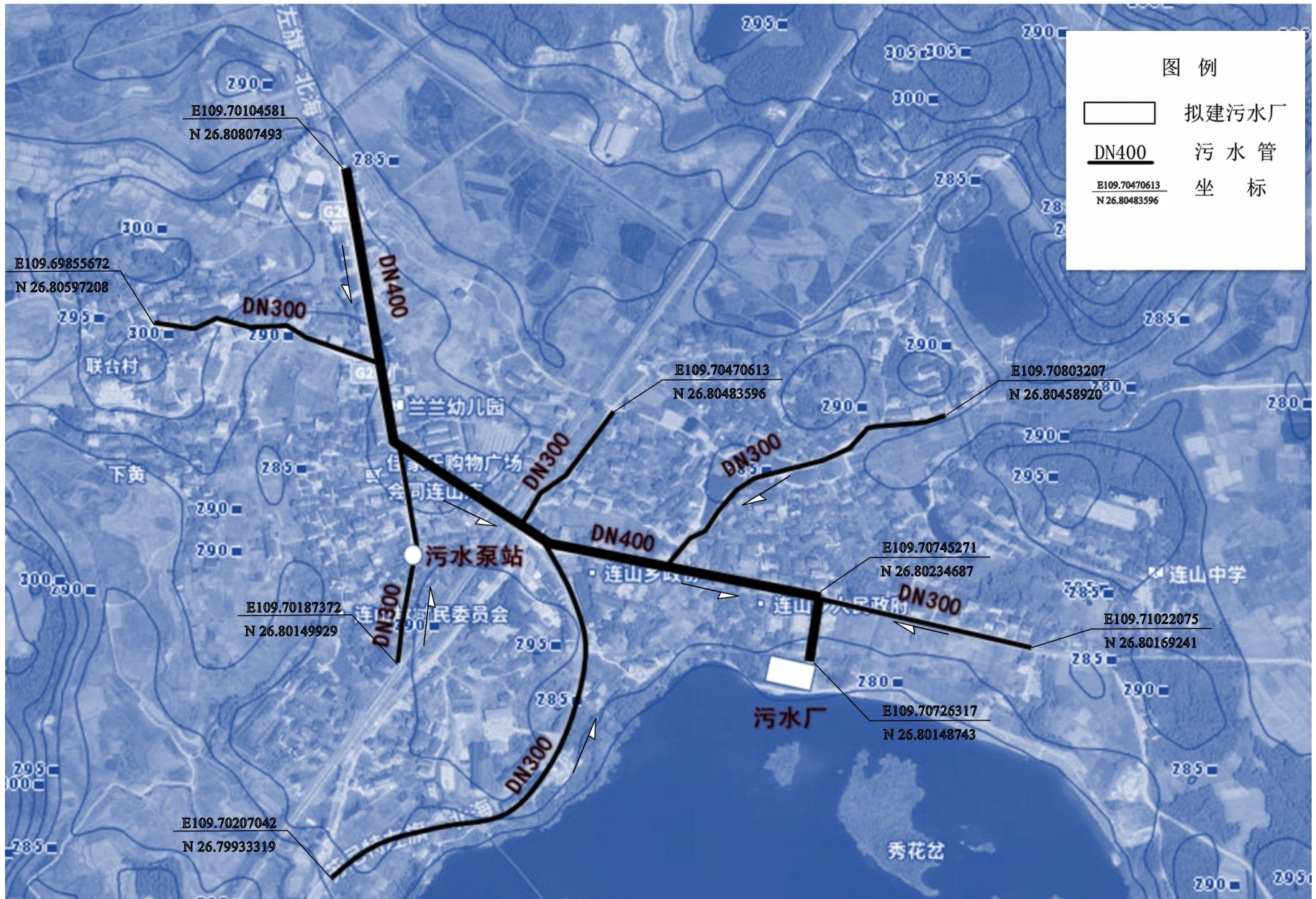
附图 2-2 连山乡集镇生活污水厂及管网布置图
